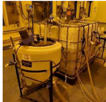
Figure 2 : Montage pour les essais en batch
